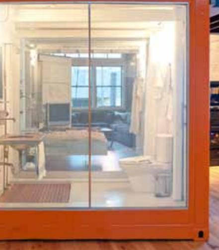
玻璃的透光效果可以切换，平时是普通高透光玻璃，如果需要一点隐私，还可以切换到液晶模式，马上变成透光但不透明的磨砂玻璃
