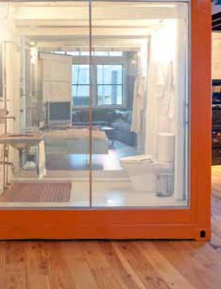
玻璃的透光效果可以切换，平时是普通高透光玻璃，如果需要一点隐私，还可以切换到液晶模式，马上变成透光但不透明的磨砂玻璃
